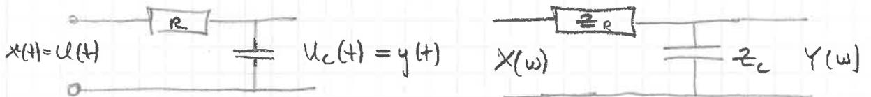
Spannungsteiler:  $H(\omega) = \frac{Y(\omega)}{X(\omega)} = \frac{Z_C}{Z_R + Z_C} = \frac{1/i\omega C}{R + 1/i\omega C} =$
