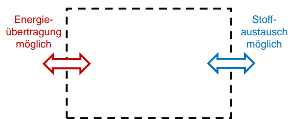
Abbildung 1.2: Offenes System mit der Möglichkeit der Energieübertragung und des Stoffaustausches (Beispiel: Schwimmbecken)
